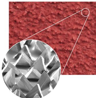
Das 3M präzisionsgeformte Dreieckskorn ist das Geheimnis der Leistungsfähigkeit des Schleifbandes. Es behält beim Schleifprozess stets scharfe Schneidkanten. Diese spanen gleichmäßig durch das Metall, haben eine dauerscharfe Wirkung und erzielen eine saubere, gratarme und gleichmäßige Oberfläche. Das Resultat ist ein schneller, kühler Schleiff und eine verlängerte Standzeit des Schleifmittels.
